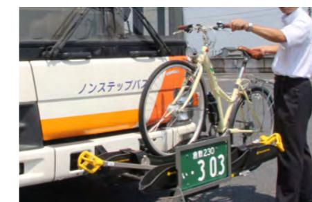
▲③固定用レバーを写真のように外し自転車をゆっくり降ろしてください。
